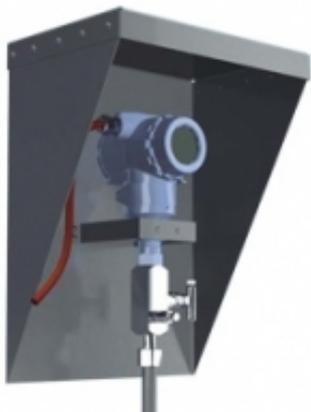
Козырек служит для защиты оборудования (ПИД датчики давления, манометры, расходомеры, уровнемеры и др.) от атмосферных механических воздействий. Изготавливается из листовой стали. Для защиты от коррозии используется порошковая покраска, либо материалом изготовления является нержавеющая сталь. Размеры козырьков в форму отдают заказчик. Крепление козырька может осуществляться на вертикальную поверхность, на вертикальную/горизонтальную стойку, трубопровод и т.д.
