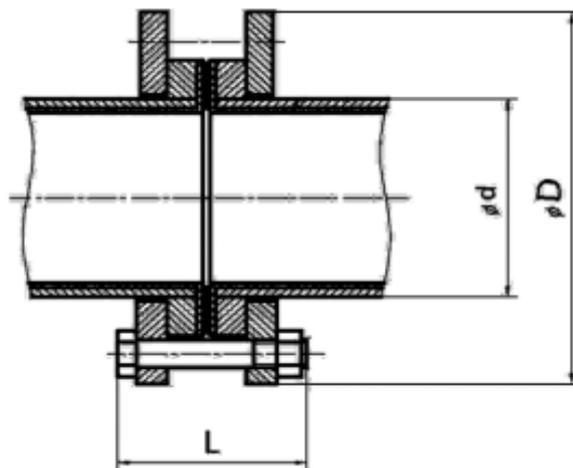
Кожух **Ф-СИЛ – 0\*** (50°С...+280°С) - **Л – D=100мм – d=40мм – L\*=130мм**
